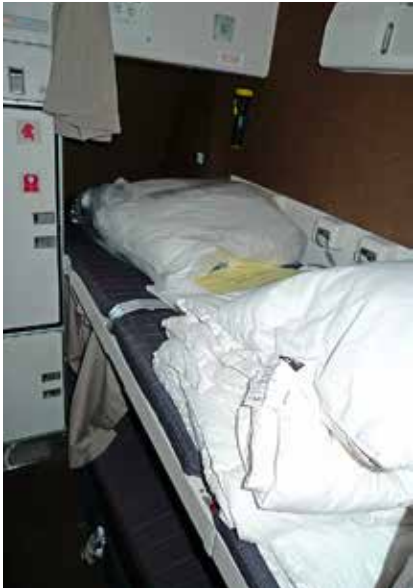
Ein Piloten-Crew-Bunk (Ruheraum) in der A340.
